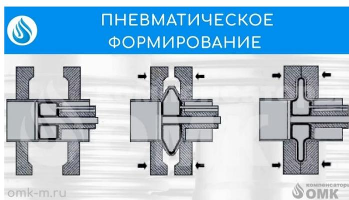
формование схоже с эластомерным. Разница заключается в применении предварительного этапа. Его суть заключается в сдавливании трубы.
