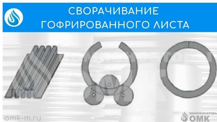
Сворачивания гофрированного металлического листа осуществляется его формовка. Для этого на заготовку оказывается давление штампами. Круглые линзы получают путем скручивания на роликовом стане. Технология сворачивания в кольцо отличается тем, что здесь отдельно формируется каждая гофра (волна). Далее из сварных линз составляется сильфон с требуемым количеством элементов.
