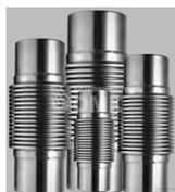
**Сильфон** — упругая однослойная или многослойная гофрированная оболочка из металлических, неметаллических и композиционных материалов, сохраняющая прочность и герметичность при многоцикловых деформациях сжатия, растяжения, изгиба и их комбинаций под воздействием внутреннего или внешнего давления, температуры механических напряжений.
