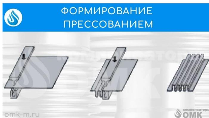
Используя этот метод можно получить разные профили гофры. Чаще всего используются U и V-образные профили. Возможность материала и метода ограничивают длину профиля. Большая длина может быть получена свариванием нескольких профилей вместе.
