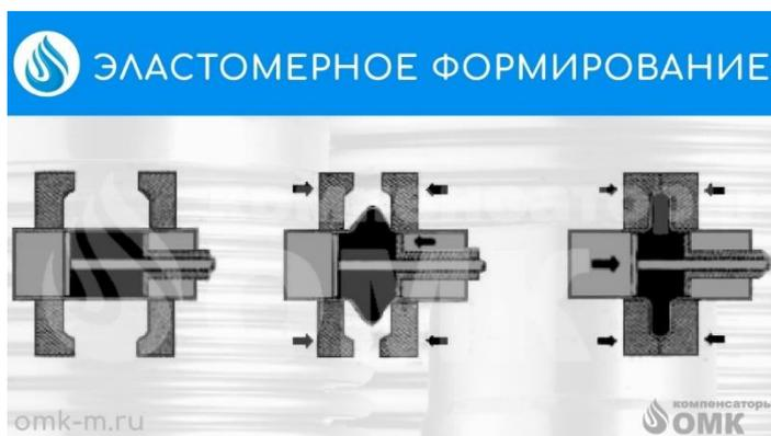
Труба вставлена в сердечник, содержащий резиновый цилиндр. Осевая сила, действующая на сердечник, растягивает резиновый цилиндр, формируя выпуклости в трубе. После этого с резинового цилиндра снимается нагрузка, а выпуклость сжимают в осевом направлении внешней силой, формируя гофру. Гофры формируются по одной. Труба укорачивается по мере формирования гофр. При необходимости данным способом можно изготавливать многоволновые сильфоны.
