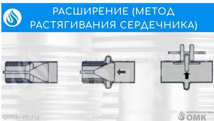
Отдельные гофры формируются в трубе путем растяжения внутреннего сердечника. Плоскость частично минимизирует расширение, труба должна немного поворачиваться. Процесс повторяют пока не достигнута необходимая высота гофры. Каждая гофра позже выравнивается в размерах посредством специальных внутренних и внешних роликов.
